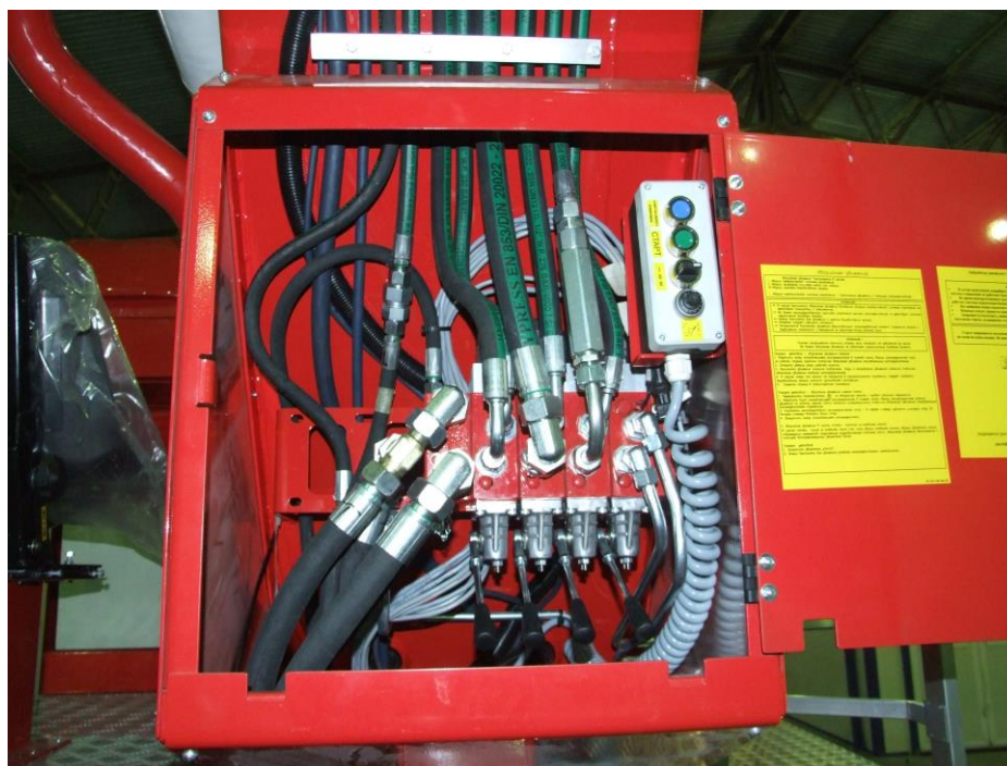
Фотография номер 8. Главный гидравлический распределитель, поз. 9 на гидравлической схеме.
