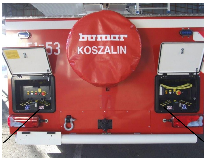
Фотография номер 13 Пульты выносных опор.
