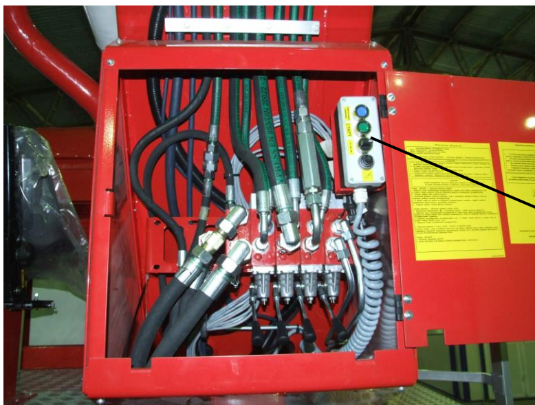
Фот. номер 15. Пульт аварийного электрического выравнивания люльки
