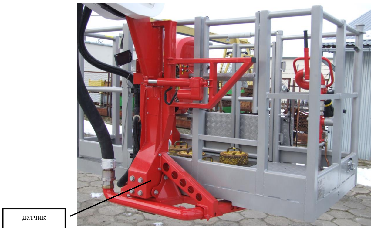
Фот. номер 34. Датчик контроля нагрузки люльки.
