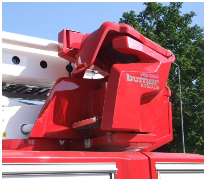
Фот № 1а – Транспортное положение поста управления
