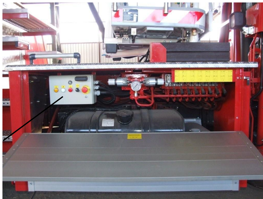
Фотография номер 14. Местонахождение пульта аварийного управления опорами
