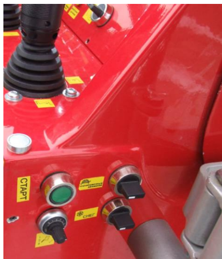
Фот. номер 17. Пульт аварийного электрического выравнивания люльки.
