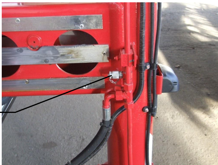
Фот. номер 49. Измерительный патрубок для получения образца масла.
