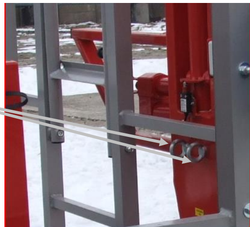
Фотография номер 3. Проушины для закрепления предохранительных поясов в люльке.
