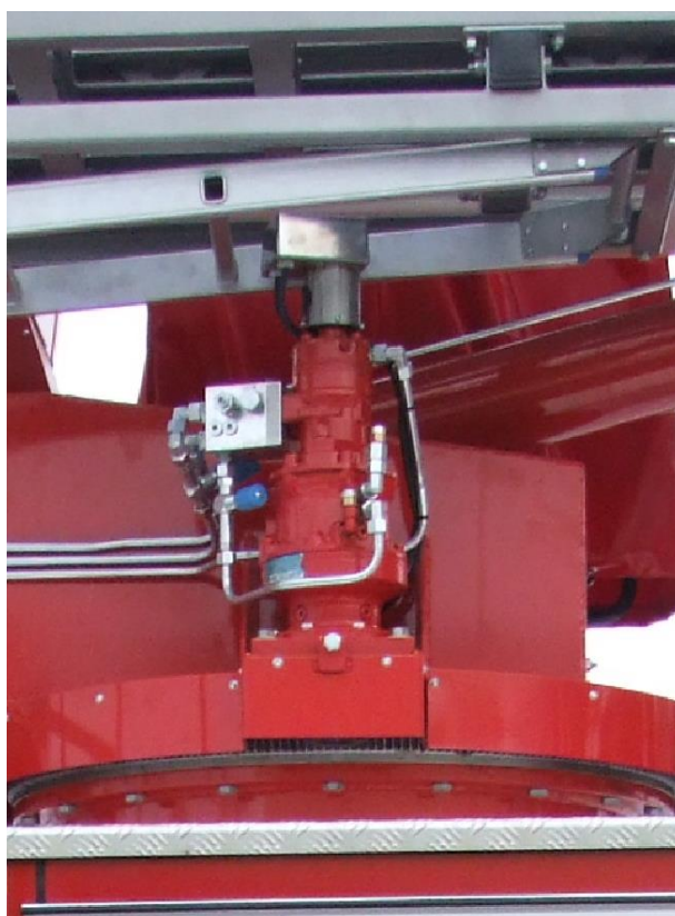
Фотография номер 9. Гидравлический двигатель поворотной колонны, поз. 27 на гидравлической схеме.
