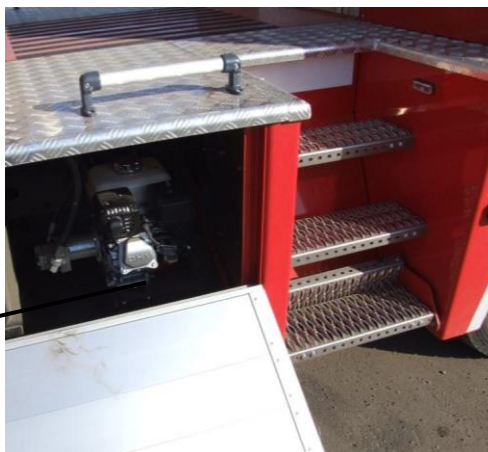
Фот. номер 21. Аварийный привод – агрегат Honda.
